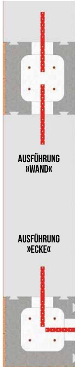
Mit der ESM®-Stützen-Dämmschalung werden z.B. Kniestockanker, Zugstützen, etc. innerhalb kürzester Zeit hergestellt. Es entfallen aufwändige Schalungsarbeiten inklusive der zeitraubenden Nebenarbeiten. Lediglich ab einer Einfüllhöhe von 2 Metern muss im unteren Bereich gegen den Betonruck gesichert werden. Auch die Wartezeit nach dem Betonieren bis zum Ausschalen entfällt. Die einzelnen Elemente haben eine Höhe von 1 Meter und können beliebig angepasst werden.
